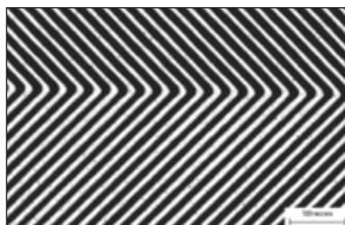
頂視圖 附註：透明區域中的微小顆粒 是 1\text{-}3\mu\text{m} 光學透明的磨砂塗層珠粒， 其用於改善真空接觸。
